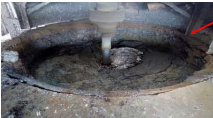
Pared de la olla (crisol) con recubrimiento (costra) que se forma por falta de limpieza
