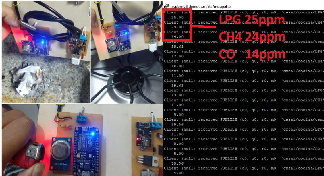
Figura 77. Prueba sensor de gas
