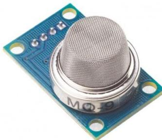
Figura 9. Sensor de gas MQ-9
