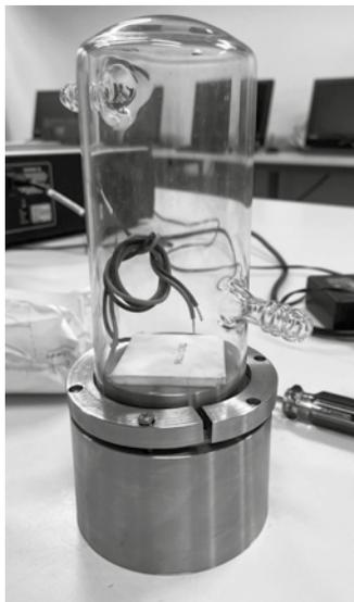
**Figura 3:** Campana de cristal sobre la base de aluminio y en su interior la celda Peltier.
