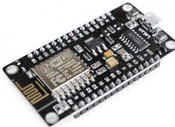
Figura 21. NODEMCU
