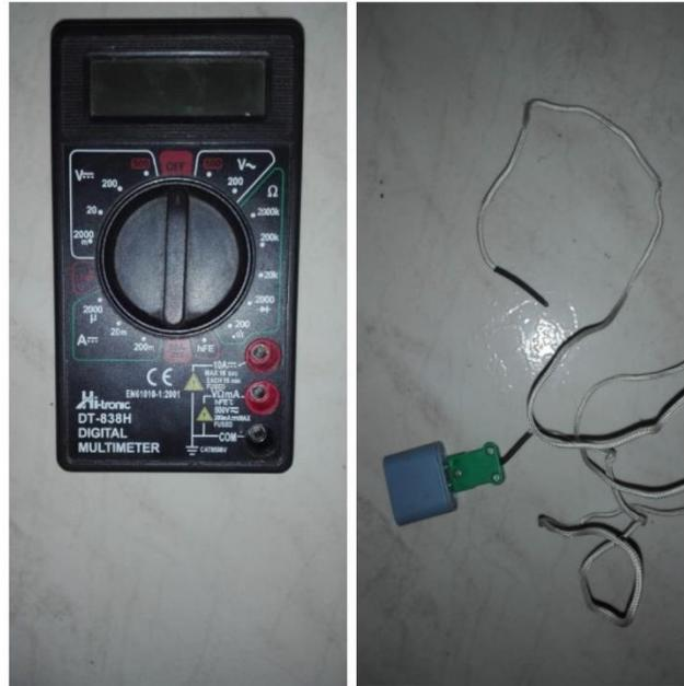
Figura 40. Multímetro digital DT-838H
