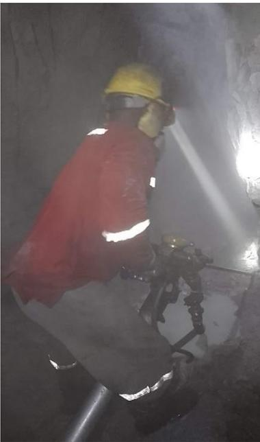
En esta imagen se presenta la actividad de investigación, que es la perforación y voladura, donde está el trabajador operando el martillo neumático con el cual hace las perforaciones para luego colocar los explosivos dentro de los orificios realizados.
