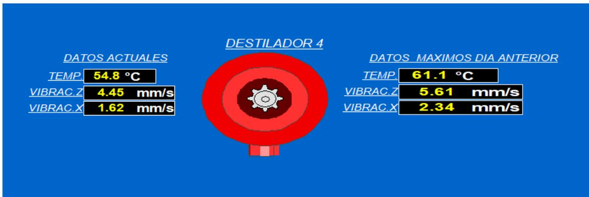
Figura 15. Valores de medición en línea de un destilador para vibración y temperatura.
